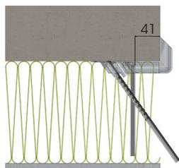
**AVANTAGE :** 2 perçages différents qui permettent de s'adapter à l'arête béton et/ou à la pièce de fixation
